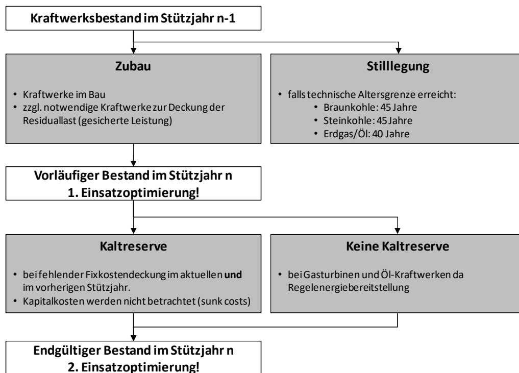
Abbildung 23: Methodik zur Ableitung des notwendigen Kraftwerksparks unter Berücksichtigung von Versorgungssicherheit und Wirtschaftlichkeit.
