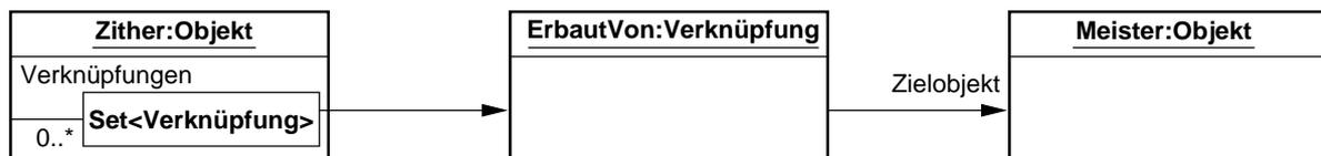
Abbildung 4.5: Objektdiagramm einer unidirektionalen Verknüpfung
